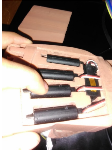
Figura 4. Servomotores en el cuerpo de la mano. Fuente: Vargas (2017).
