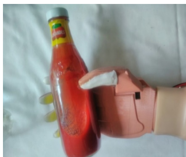
Figura 11. Prueba de sujeción del máximo diámetro de agarre del prototipo. Fuente: Vargas (2017).
