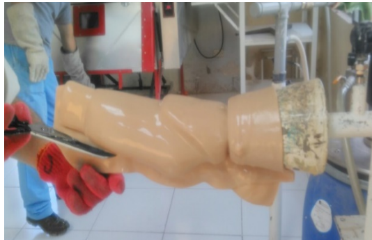
Figura 8. Moldeado del plástico PVC en el molde de yeso. Fuente: Vargas (2017).
