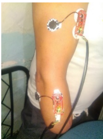
Figura 6. Ubicación de los sensores MyoWare en el usuario. Fuente: Vargas (2017).
